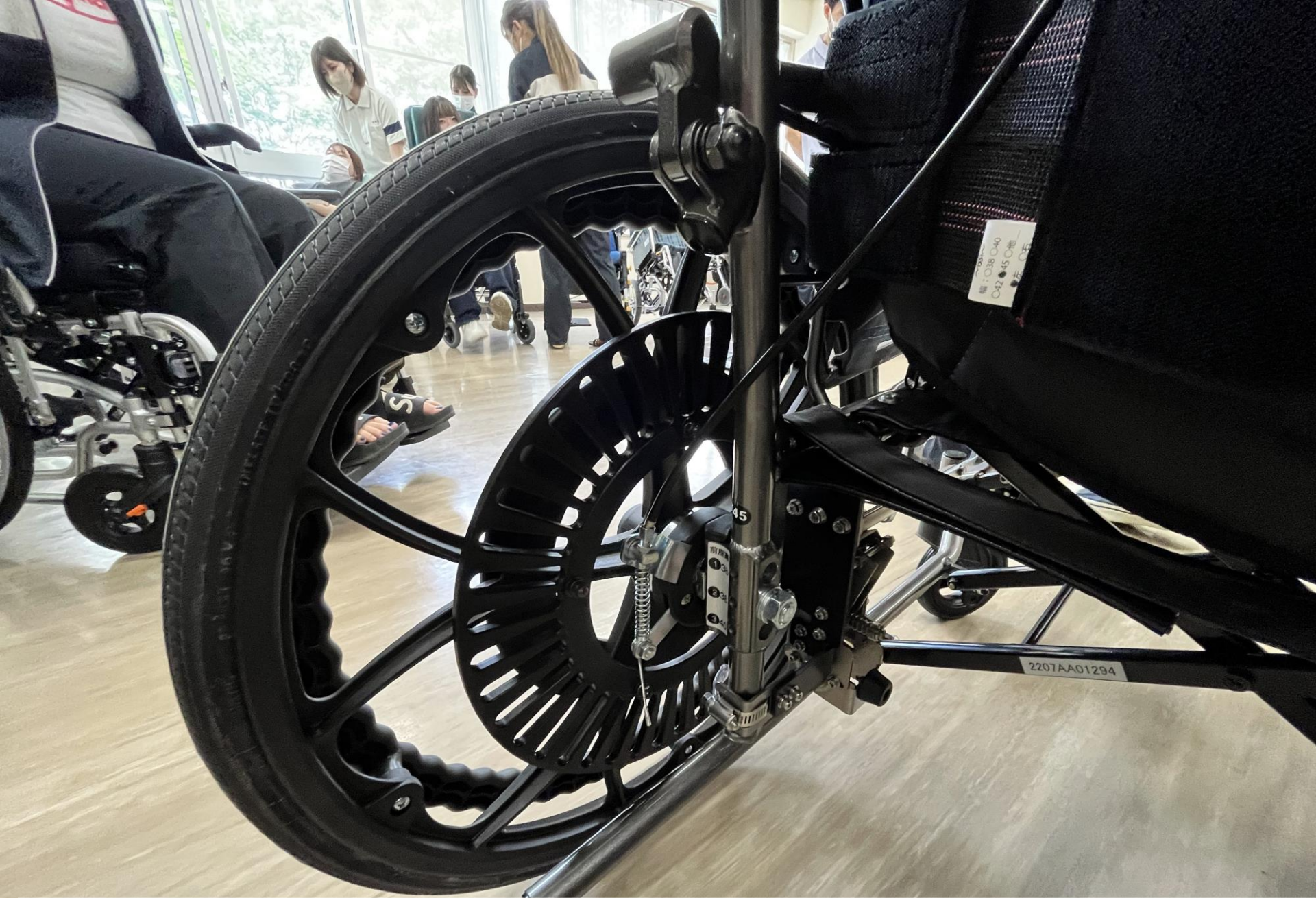
自動制御システムのブレーキユニット部分
